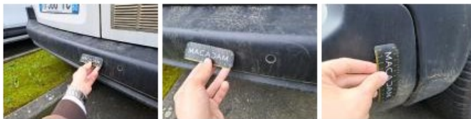
Pare-chocs AR, Griffe(s), Dépose/Répose
