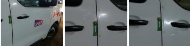
Boitier rétroviseur ext D, Griffe(s), E - Remplacer
