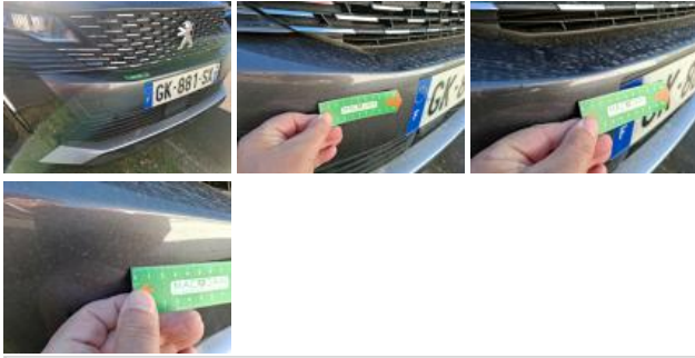
Aile ARD, Mauvaise réparation, Peindre
