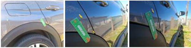
Porte ARD, Mauvaise réparation, Peindre
