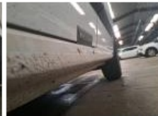
Bas de caisse ext G, Bosse(s), LI - Réparer et peindre (complet)
