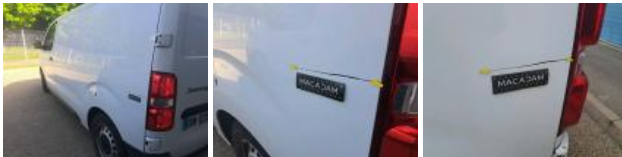
Panneau ARD, Trou, LI - Réparer et peindre (complet)
