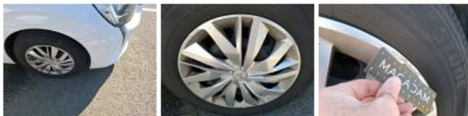
Enjoliveur de roue AVG, Cassé, E - Remplacer
