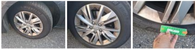
Pneu AVG, Déchirure, E - Remplacer
