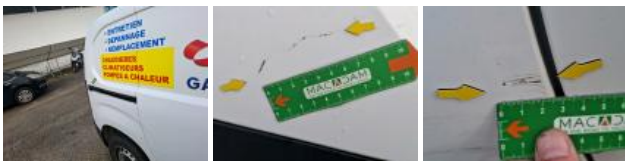
Montant de toit D, Bosse(s), LI - Réparer et peindre (complet)
