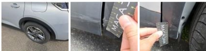
Moulure d'aile ARG, Griffe(s), Réparer/remplacer (montant forfaitaire)
