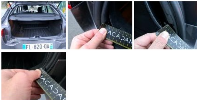
Joint de coffre/hayon, Déchirure, E - Remplacer
