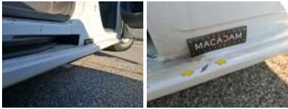
Porte de malle AR G, Bosse(s) et griffe(s), LI - Réparer et peindre (complet)
