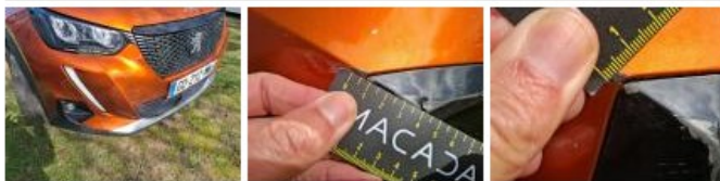
Moulure de pare-chocs AVD, Déformé / Forcé, Le - Remplacer et peindre
