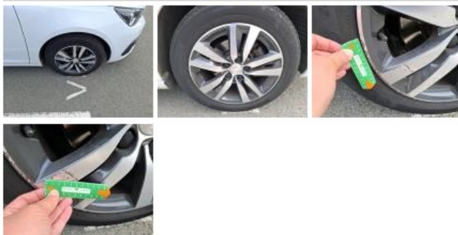
Pneu AVD, Hors tolérance, E - Remplacer
