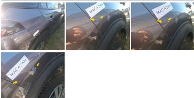
Moulure d'aile ARD, Griffe(s), Acceptable
