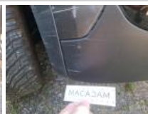
Moulure de pare-chocs AV, Griffe(s), E - Remplacer
