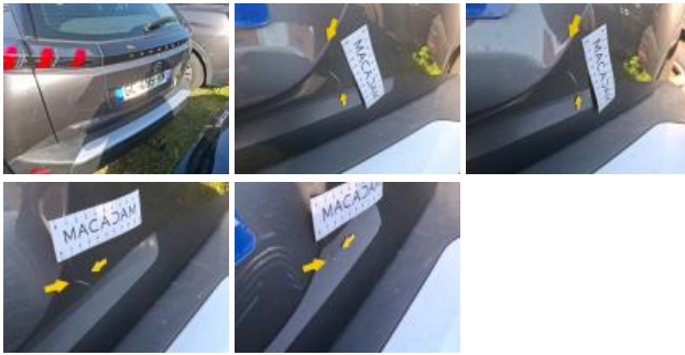
Moulure de pare-chocs AR, Griffe(s), E - Remplacer
