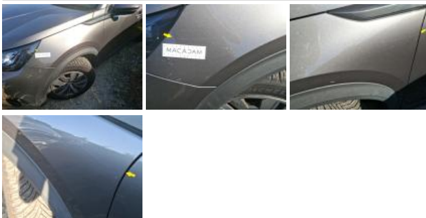
Moulure d'aile AVG, Griffe(s), E - Remplacer
