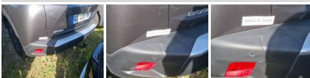
Pare-chocs AR, Déformé / Forcé, E - Remplacer
