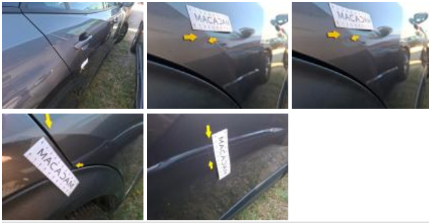
Moulure porte AVD, Griffe(s), E - Remplacer
