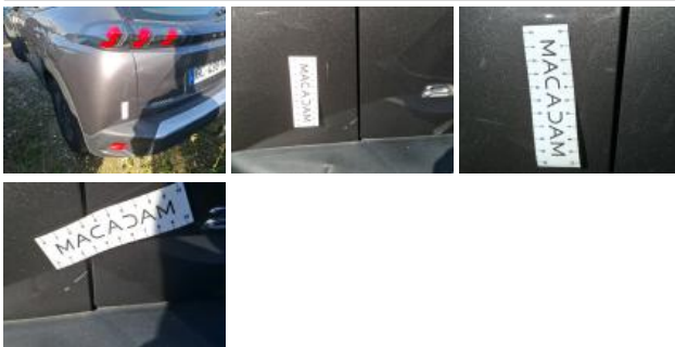
Pare-chocs AR, Déformé / Forcé, E - Remplacer
