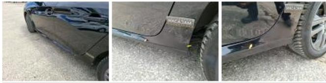
Moulure de pare-chocs AV, Dégrafé, Dépose/Répose
