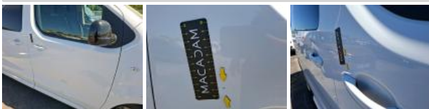
Montant de toit D, Bosse(s) et griffe(s), LI - Réparer et peindre (complet)
