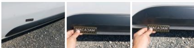
Moulure porte AVD, Griffe(s), E - Remplacer
