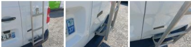
Pare-chocs AR, Griffe(s), E - Remplacer
