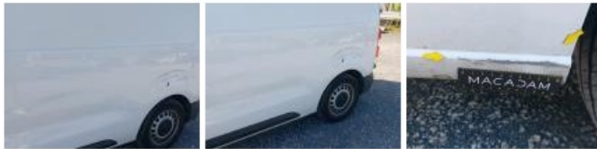
Obturbateur /Cache AV, Manque, E - Remplacer
