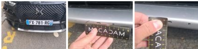
Moulure de pare-chocs AVG, Griffe(s), E - Remplacer
