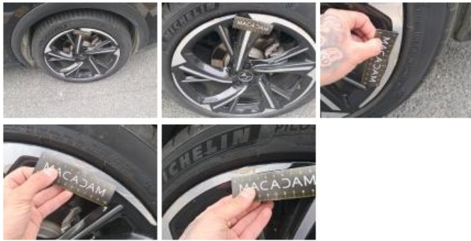
Pneu ARG, Déchirure, E - Remplacer
