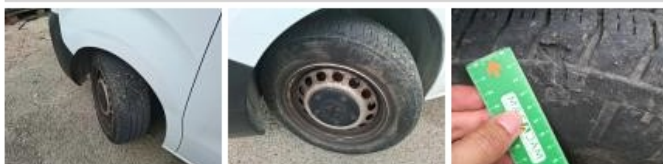
Pneu AVD, Hors tolérance, E - Remplacer
