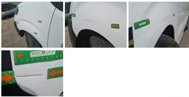
Moulure porte AVG, Manque, E - Remplacer
