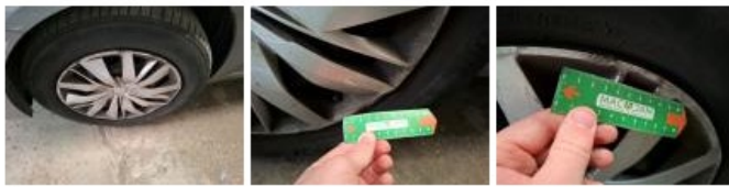
Pneu AVD, Hors tolérance, E - Remplacer
