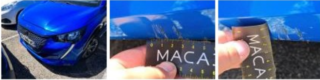
Boitier rétroviseur ext D, Griffe(s), Lustrage
