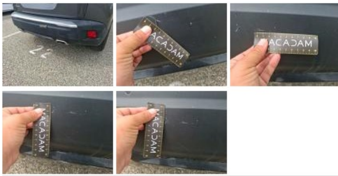
Moulure de pare-chocs AR, Griffe(s), Acceptable
