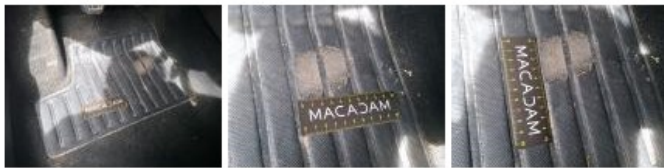
Bas de caisse int ARD, Bosse(s) et griffe(s), Acceptable
