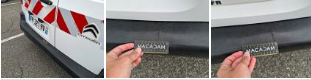
Coin pare-chocs ARG, Déformé / Forcé, LI - Réparer et peindre (complet)
