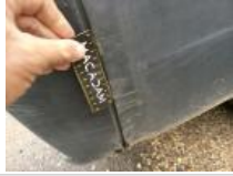
Coin pare-chocs ARD, Griffe(s), LI - Réparer et peindre (complet)
