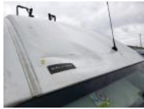
Pavillon cabine, Bosse(s), LI - Réparer et peindre (complet)
