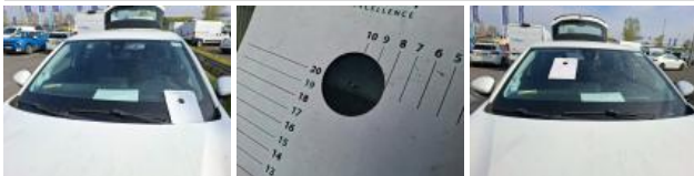
Pare-brise, Eclat(s), Réparation pare-brise 2 éclats
