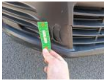
Moulure de pare-chocs AVD, Déformé / Forcé, E - Remplacer
