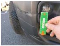
Moulure de pare-chocs AVD, Déformé / Forcé, E - Remplacer
