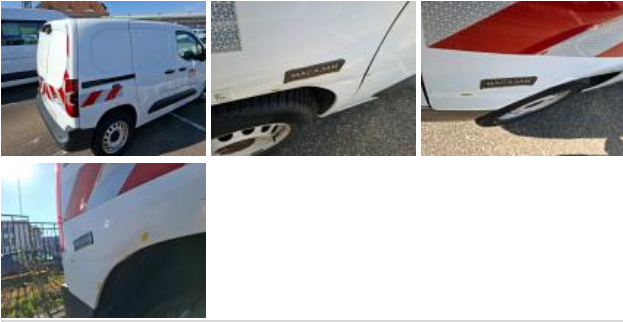
Porte coulissante D, Bosse(s) et griffe(s), LI - Réparer et peindre (complet)
