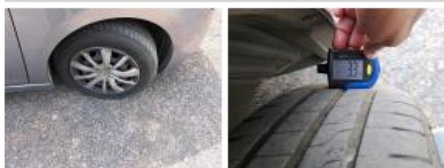
Enjoliveur de roue AVD, Déformé / Forcé, E - Remplacer
