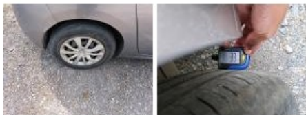
Pneu AVD, Hors tolérance, E - Remplacer
