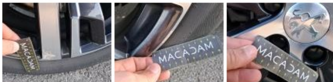
Pneu AVD, Hors tolérance, E - Remplacer
