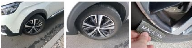
Pneu AVG, Hors tolérance, E - Remplacer
