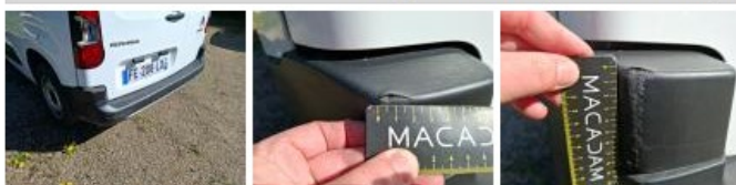
Pare-chocs AR, Griffes(s), E - Remplacer
