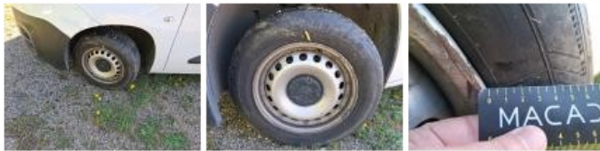
Jante tôle AVG, Déformé / Forcé, Acceptable
