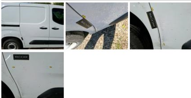
Moulure porte ARD, Griffes(s), E - Remplacer
