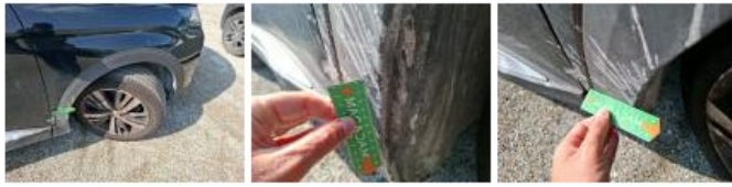
Moulure d'aile AVD, Déformé / Forcé, E - Remplacer
