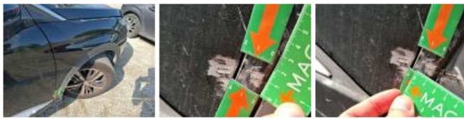
Moulure d'aile AVD, Déformé / Forcé, E - Remplacer
