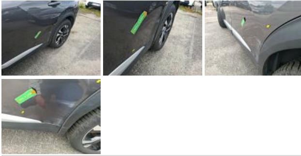
Moulure porte ARG, Déformé / Forcé, E - Remplacer
