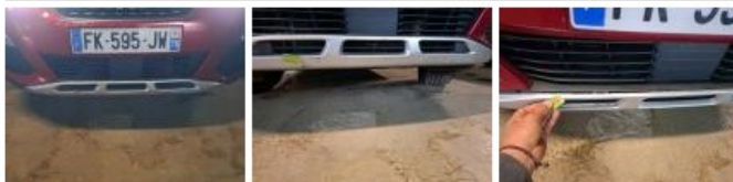
Grille de pare-chocs AV M, Dégrafé, Dépose/Répose
