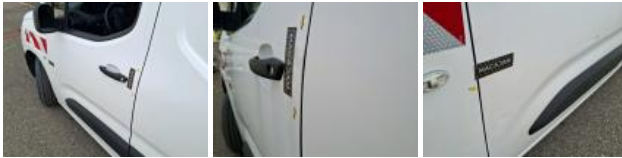
Moulure porte AVG, Griffe(s), Réparer/rempl. (montant forfaitaire)
