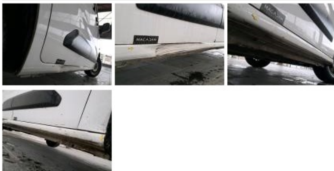
Aile AVD, Bosse(s), Le - Remplacer et peindre
