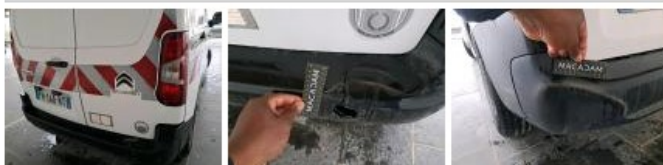
Obtuteur /Cache AR, Manque, E - Remplacer
