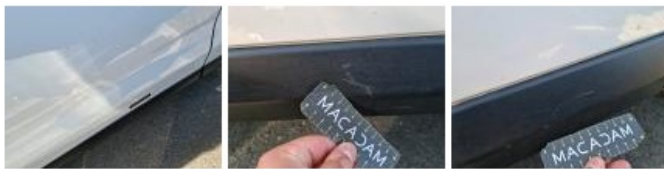
Pare-chocs AR, Griffe(s), E - Remplacer
