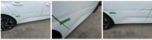
Porte AVD, Bosse(s) et griffe(s), LI - Réparer et peindre (complet)
