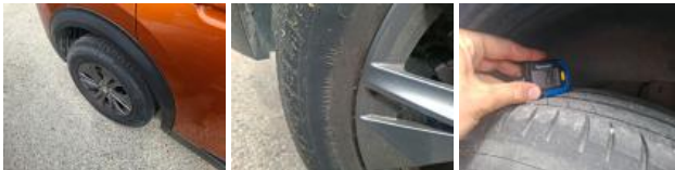
Pneu AVD, Hors tolérance, E - Remplacer
