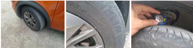
Pneu ARG, Hors tolérance, E - Remplacer
