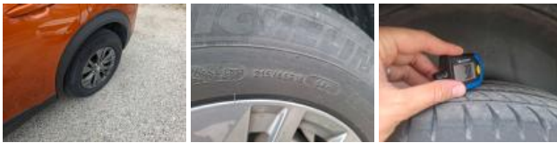
Pneu ARD, Hors tolérance, E - Remplacer
