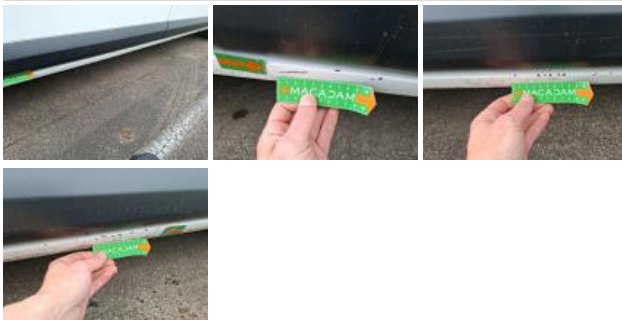
Moulure porte AVD, Griffe(s), Réparer/rempl. (montant forfaitaire)
