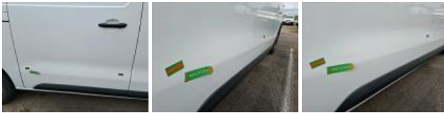
Panneau Latéral G, Bosse(s) et griffe(s), LI - Réparer et peindre (complet)
