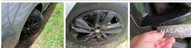
Pneu AVD, Hors tolérance, E - Remplacer
