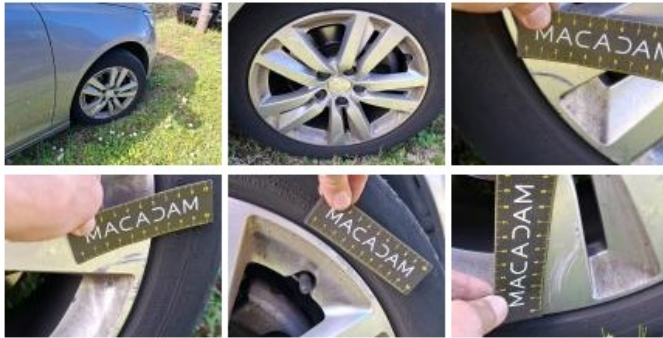
Pneu AVD, Hors tolérance, E - Remplacer
