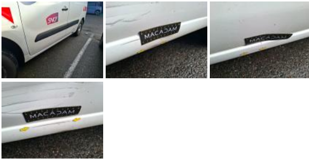
Panneau ARG, Bosse(s) et griffe(s), LI - Réparer et peindre (complet)
