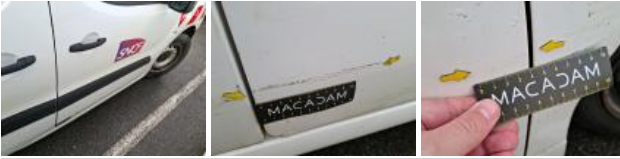
Coin pare-chocs ARG, Dégrafé, Dépose/Repose
