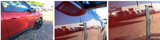
Boitier rétroviseur ext D, Griffe(s), Acceptable
