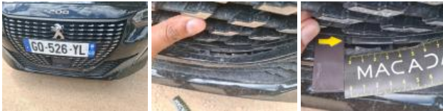
Grille de pare-chocs AV M, Griffe(s), E - Remplacer
