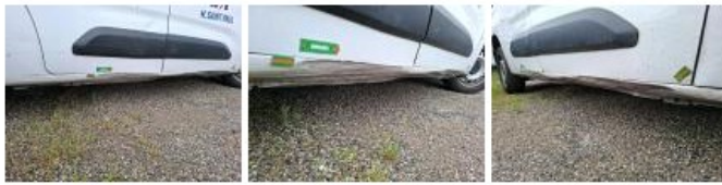
Moulure porte AVD, Griffe(s), E - Remplacer
