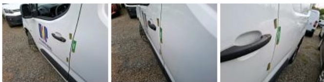
Moulure porte AVG, Griffe(s), Réparer/rempl. (montant forfaitaire)
