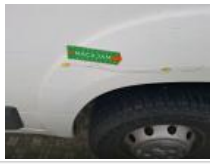
Panneau Latéral D, Bosse(s), LI - Réparer et peindre (complet)
