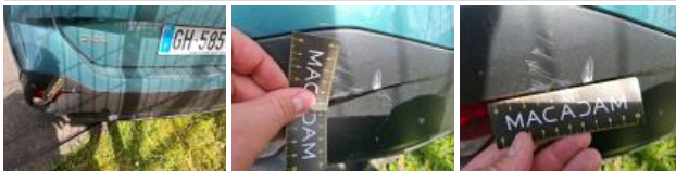
Moulure de pare-chocs AR, Griffe(s), E - Remplacer
