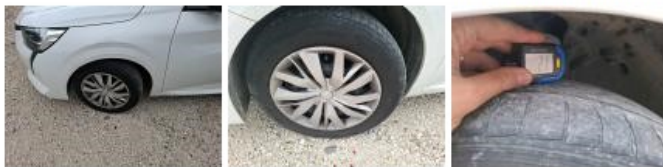
Pneu AVD, Hors tolérance, E - Remplacer
