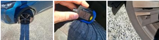
Pneu ARG, Hors tolérance, E - Remplacer
