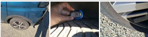
Pneu ARD, Hors tolérance, E - Remplacer
