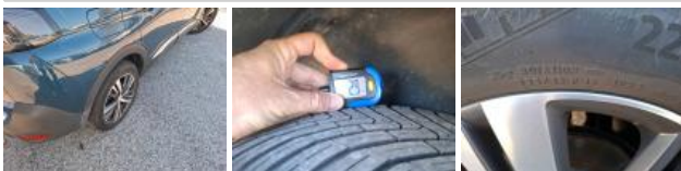
Pneu AVD, Hors tolérance, E - Remplacer
