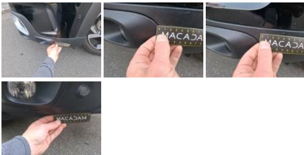
Moulure de pare-chocs AVG, Griffes(s), Réparer/rempl. (montant forfaitaire)
